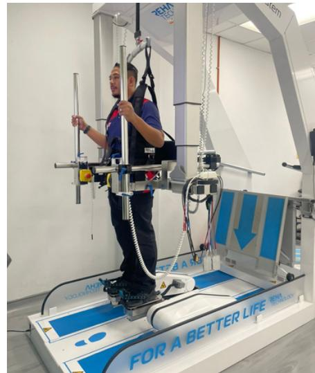
Gambar menunjukkan peralatan robotik untuk latihan cara berjalan (gait) bagi meningkatkan mobiliti pesakit yang terjejas akibat strok atau penyakit saraf lain. Rawatan pemulihan terkini secara fisioterapi robotik oleh ini ditawarkan di Pusat Perubatan Universiti Sains Malaysia Bertam (PPUSMB)
